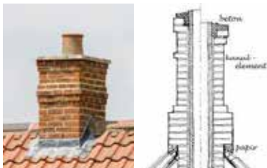
Referencefotos der viser eksempel på ventilationsanlæg med afkast gennem muret skorstensattrap med udseende som eksisterende murede skorstene..
